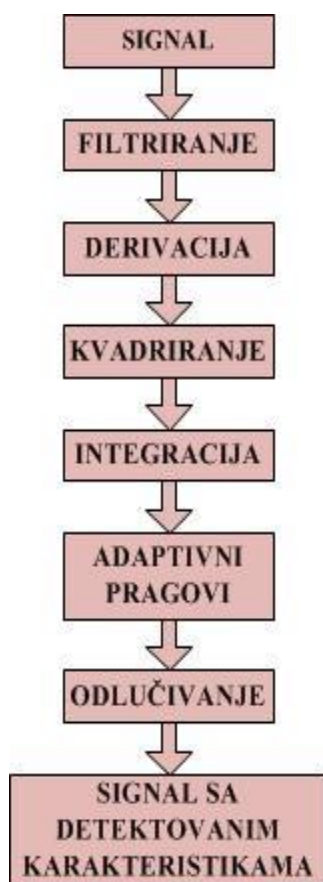
Slika 21: Blok dijagram Pan i Tompkins algoritma.
